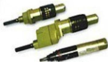
Пневматические приводы предназначены к использованию в составе многошпиндельных сборочных систем для сборки и разборки резьбовых соединений, а также могут применяться и в составе другого технологического оборудования.
