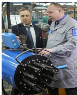
С 2013г. РИЗ ОАО «КАМАЗ» совместно с ЗАО «Инструм-Рэнд» освоил производство многошпиндельных сборочных систем с механическим отключением (точность момента затяжки до  $\pm 10\%$ ) и с электронной системой управления по моменту затяжки (точность момента затяжки до  $\pm 5\%$ ), а также цифровой обработкой получаемых данных.
